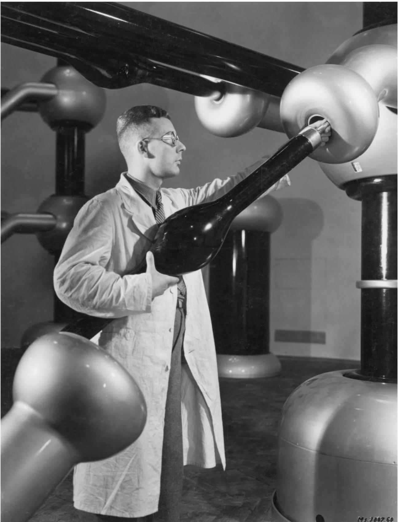
Einsetzen einer Kathodenröhre in einen dreistufigen Gleichstrom-Hochspannungsgenerator, Berlin 1942
