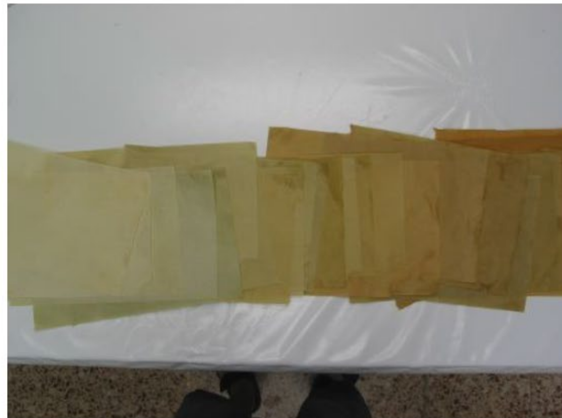
Fehlstellenergänzung mit Heizspatel auf dem Saugtisch (links) und angefärbte Japanpapiere in verschiedenen Farbtönen (rechts)
