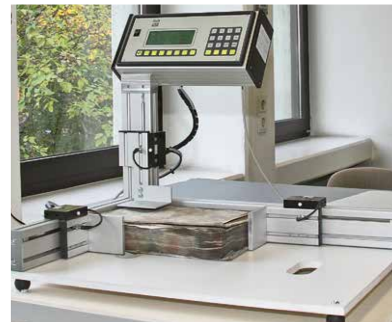
Millimetergenaue Vermessung von Amtsbüchern zur Vorbereitung von maßgenauen Verpackungen zur Verbesserung der Lagerungsbedingungen (Licht- und Staubschutz).
