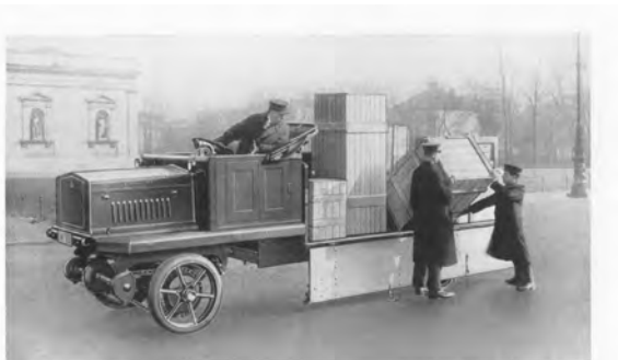
Elektrolastwagen für 2 bis 3 t Nutzlast mit tiefliegendem Hinterwagen.
