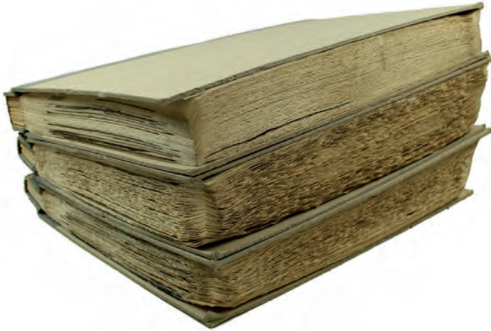
Abb.15: Heute zeigen die meisten laminierten Bände einen deutlichen Volumenzuwachs durch die Veränderung der Folie (Bayerisches Hauptstaatsarchiv, Briefprotokolle Staatsarchiv Landshut, Passau 406 II und Passau 408 I–II).
