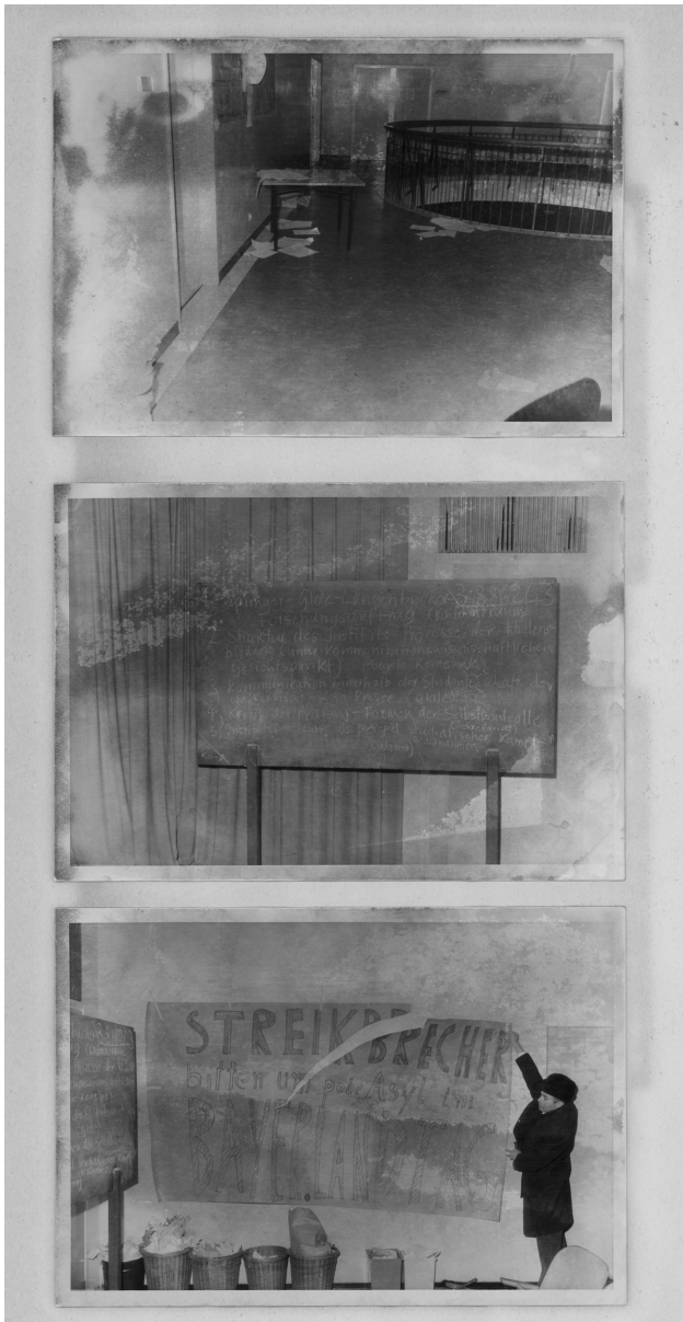
Schäden an Fotoabzügen durch ungeeigneten Klebstoff (Staatsarchiv München, Polizeidirektion 15976).
