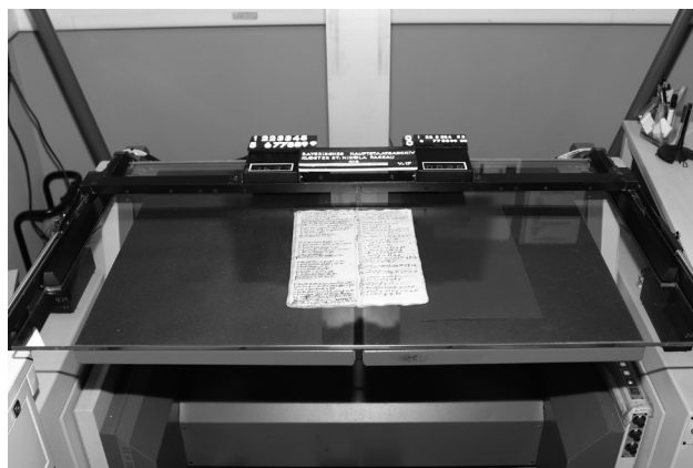
Verfilmung an einer Zeutschel-Kamera OK 401. Verfilmt wird ein Ausgaberegister des Klosters St. Nikola bei Passau aus den Jahren 1390 bis 1396.
