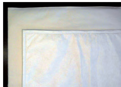
Urkundenunterlage mit Außenhülle nach dem LWL-System (unten), Paramoll mit Tyvekdeckschicht vernäht (oben)
